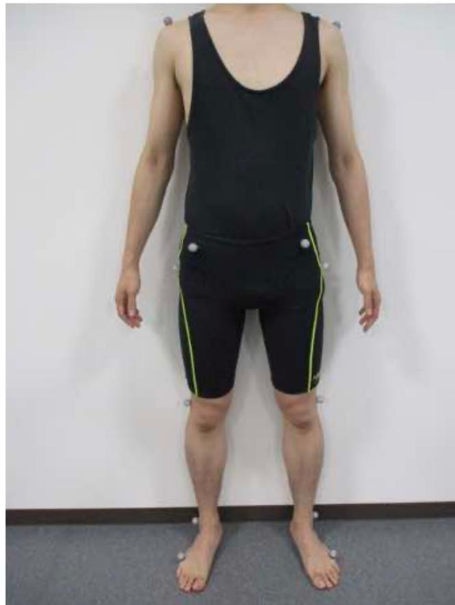
図 9. 反射マーカの貼り付け部位
